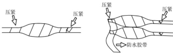
3. 用随机附带的防水套件对网线进行防水处理，如图所示依次将防水套件套在网线上。
