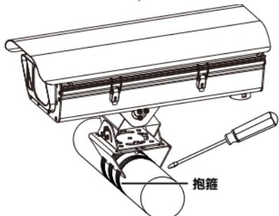
3. 松开三维可调安装支架四周螺钉，调节支架角度，使设备面对检测区域，然后锁紧螺钉。
