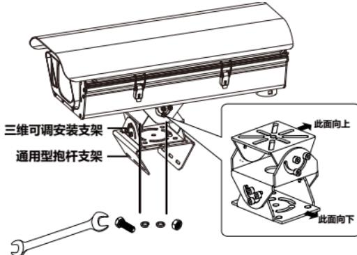
2. 将抱箍穿过通用型抱杆支架底部孔洞，环绕固定至横杆。使用螺丝刀转动抱箍上的固定螺钉，将抱箍收紧至合适大小。
