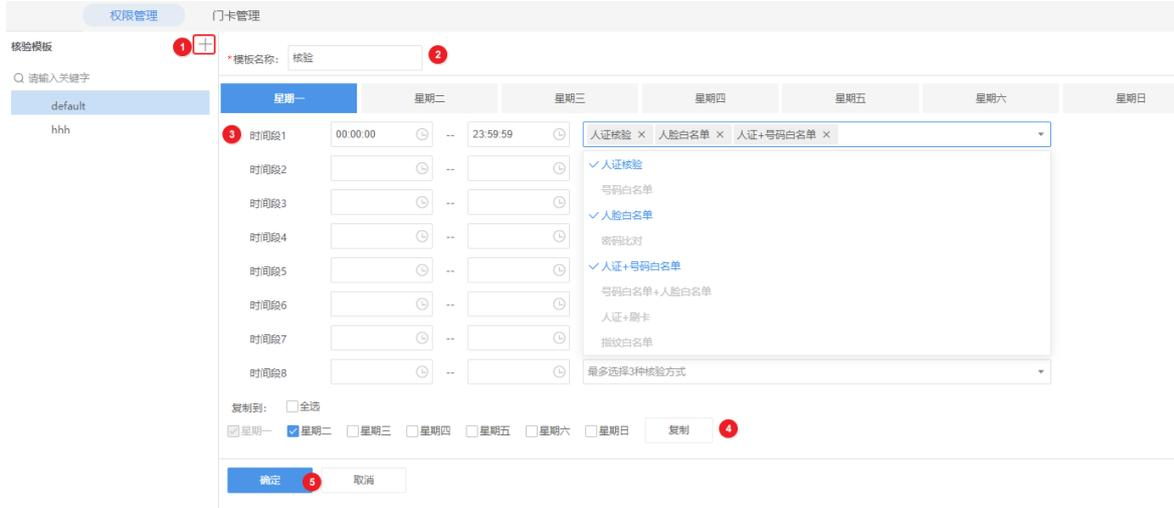
该截图展示了“门卡管理”下的“核验模板”配置界面。界面顶部有“权限管理”和“门卡管理”标签。左侧是模板列表，包含“default”和“hhh”。主区域显示了模板名称“核验”（标注2），以及按星期一至星期日的时段配置表。配置表包含“时间段1”至“时间段8”，每个时段可设置开始/结束时间（标注3）和核验方式（标注4）。核验方式列表包括：人证核验、人脸白名单、人证+号码白名单、号码白名单、人脸白名单、密码比对、人证+号码白名单、号码白名单+人脸白名单、人证+刷卡、指纹白名单。底部有“复制到”选项（标注5）和“确定”、“取消”按钮。
