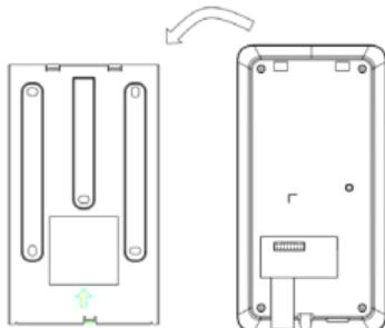
6. 将防拆螺钉从设备底部拧入，使设备与支架固定。
