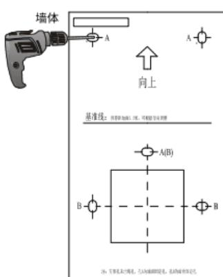
4. 将支架下方两孔对准 86 盒上的孔位，用十字螺钉将支架与 86 盒紧固。
