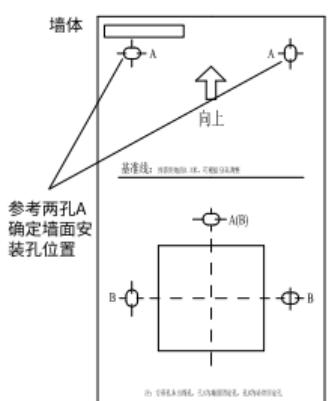
3. 用电钻在墙面相应位置开两个孔（深 30mm, 直径 6mm~6.5mm），避免打到墙内预埋线，然后向孔内预埋膨胀螺栓。
