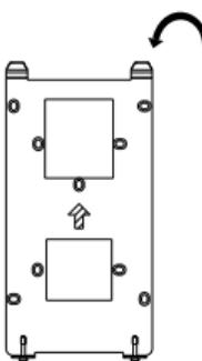
7. 在设备底部, 用 L型扳手顺时针拧入防拆螺钉 (2颗)。
