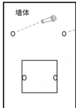
5. 固定支架。支架下孔口对准墙面及 86 安装盒上的安装孔，用十字螺丝刀顺时针拧紧螺丝，固定支架，详见下图。
