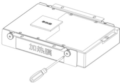
4. 将弹垫和平垫依次套入固定螺钉，使用固定螺钉将硬盘安装支架固定到 L 型上盖内壁。
