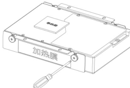
4. 将弹垫和平垫依次套入固定螺钉，使用固定螺钉将硬盘安装支架固定到L型上盖内壁。
