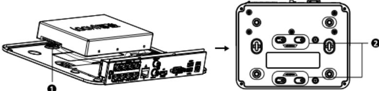
3. 更换新硬盘，并从底部用螺钉将硬盘与底座固定，连接好线缆。
