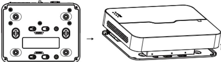
2. 将硬盘侧的线缆拔下，从底部将固定硬盘与底座的四颗螺钉拧下，将旧硬盘取下。
