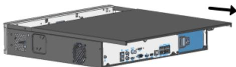
3. 4 盘位设备请将上层挂架按箭头方向旋转一定角度后，再向后抽出，取下挂架。8 盘位与 9 盘位请重复相同操作，取下下层挂架。
