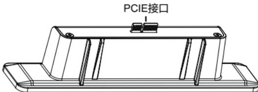
安装时请将无线模块的 PCIE 接口对准并插入设备下方的 PCIE 插槽，使无线模块吸附固定至设备即可。
