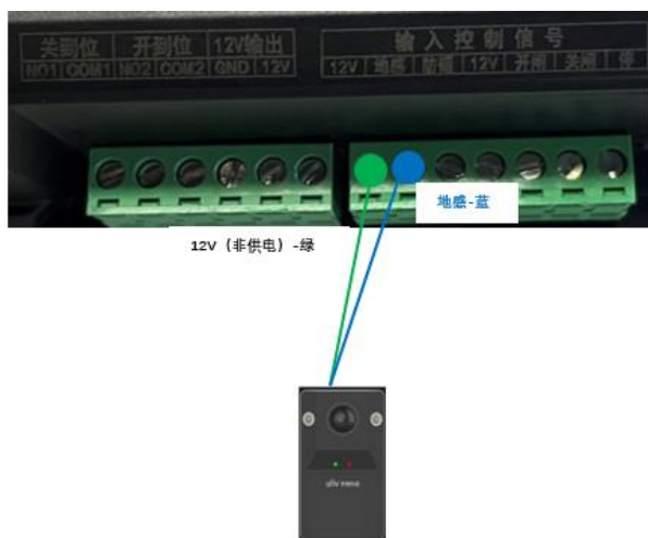
图6-10 PKG6401 道闸控制板接线图
