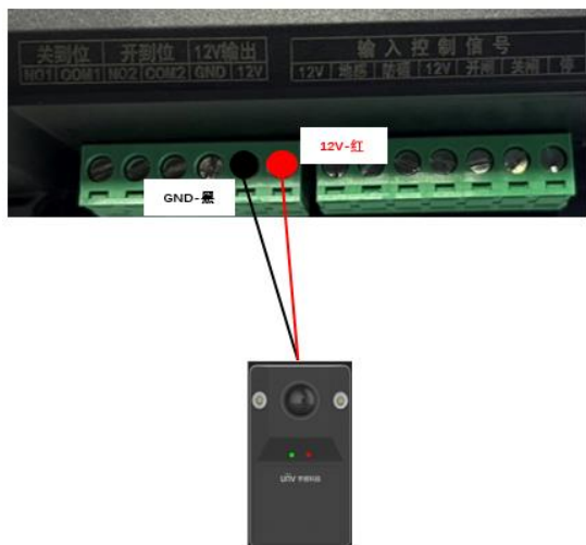
图6-6 配合 PKG5301 及 PKG5401 道闸电源接线
