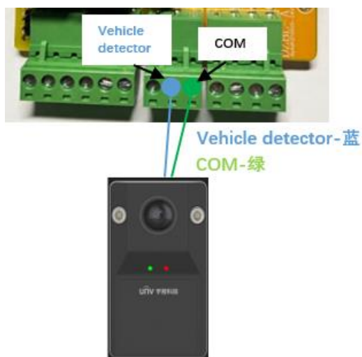
图6-9 PKG5301、PKG5401、PKG5401H 道闸控制板接线图
