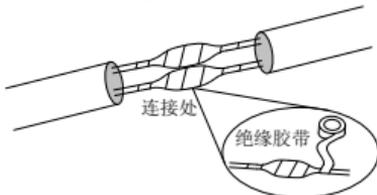
2. 用防水胶带（部分设备随箱附带，若无则需自行购买）对线缆进行防水处理。
