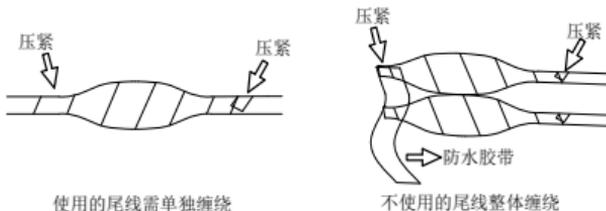
3. 用随箱附带的防水套件对网线进行防水处理，如图所示依次将防水套件套在网线上。
