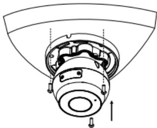
4. 将防护外罩螺钉孔与底座尾线侧出口对齐，装回防护外罩。
