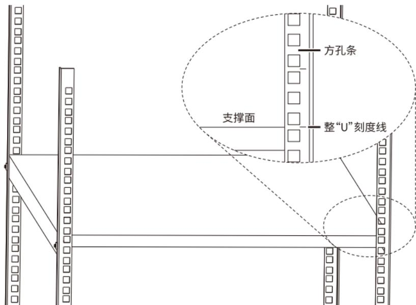
2.按照设备两侧挂耳中螺钉孔的位置，将机柜附带的 4 颗浮动螺母固定到两侧方孔条上。
