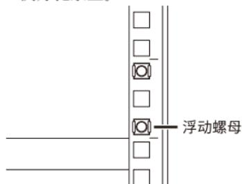
3.将设备沿着托盘推入机柜，使挂耳上的螺钉孔与浮动螺母对齐。
