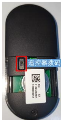
图5-13 遥控器拨码开关
