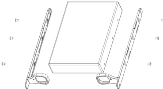
2.拆卸前面板。使用十字螺丝刀拧开前面板螺钉。
