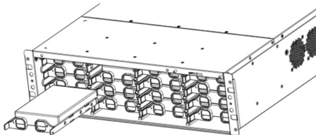
4.扣上硬盘。用拇指推进硬盘，听到“咔”的声响，完成该硬盘安装。
