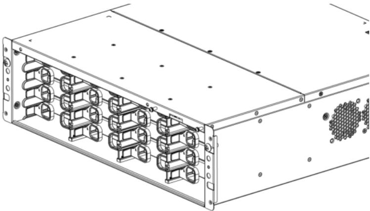
5. 安装前面板。使用十字螺丝刀拧紧前面板螺钉。
