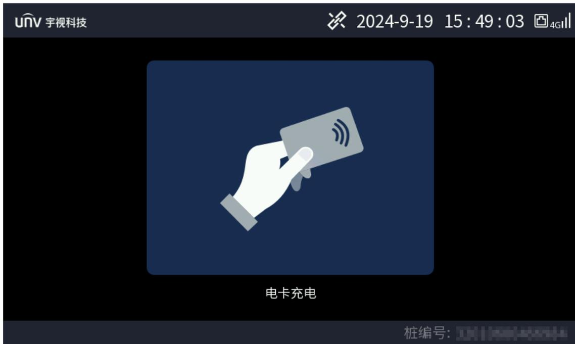
2. 将卡片置于充电桩刷卡区，若指示灯变为蓝色，界面显示充电进度，则代表启动充电。
