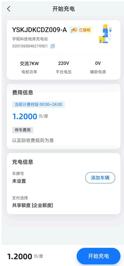
4. 点击下方的<开始充电>。APP、小程序、充电桩界面均显示充电进度，同时指示灯变为蓝色。
