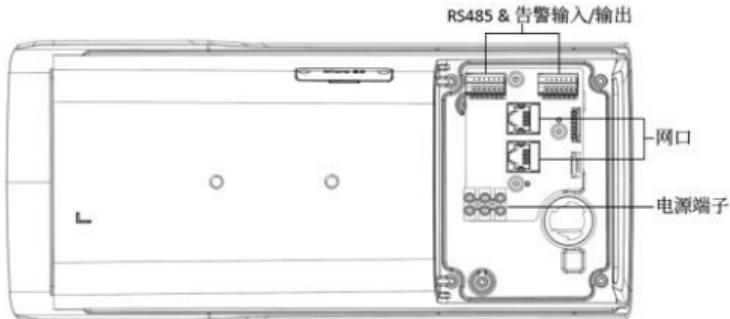
将网线、电源线（建议使用 RVV3\*1）、RS485 线、告警输入输出线从波纹管穿出，再从设备后盖的过线口穿入。
