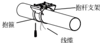
3. 将设备连接的万向节固定在抱杆支架上。
