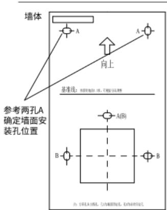
3. 用电钻在墙面相应位置开两个孔（深 30mm, 直径 6mm~6.5mm），避免打到墙内预埋线，然后向孔内预埋膨胀螺栓。
