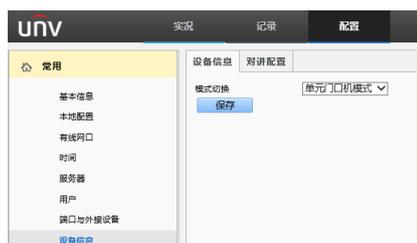
(2) 进入 [对讲配置] 可配置呼叫协议和设备位置的设置。室内机呼叫协议有 3 种：①E1-3 系列室内机②E1-B 系列室内机③VLR-V2，其中 E1-371B-H/款室内机选择呼叫协议 E1-3 系列室内机，E1-B32H 款室内机选择呼叫协议 E1-B 系列室内机。
