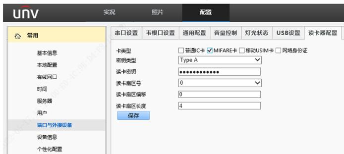
在 IC 卡加密配置中，可以进行密钥类型、读卡密钥、读卡扇区号、读卡扇区偏移和读卡扇区长度配置，具体可参 IC 卡加密配置表。
