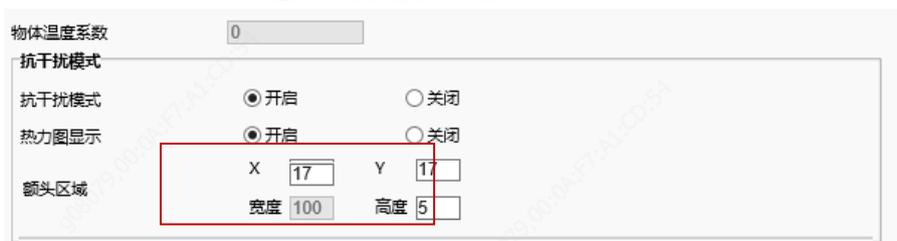
(7) 调整额头区域参数，修改 X 值时红色测温框水平偏移，修改 Y 值时红色测温框垂直偏移。测温框宽度不可更改，更改高度使测温框长度发生变化。
