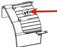
2. 将帽檐紧贴护罩下方，按照图示方向水平推入，直至卡紧护罩。
