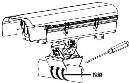
2. 松开三维可调安装支架四周螺钉，调节支架角度，使设备面对检测区域，然后锁紧螺钉。
